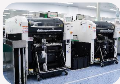
Montage en surface
